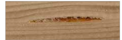
Harzganzen mit Entharzer entfernen
