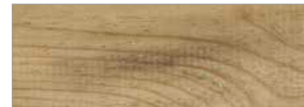
Stockflecken mit chlorhalt. Reiniger entfernen
